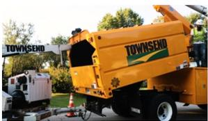
No coloque el cuerpo entre la tolva de descarga levantada y el bastidor, ni ninguna otra parte del vehículo o del suelo, sin el bloqueo correcto.
