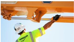
Nunca haga tareas de mantenimiento, ni siquiera limpie debajo de una tolva de descarga levantada, si no está preparado para ello.
