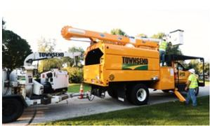
Las tolvas de descarga deben estar totalmente bajas o bloqueadas para repararlas o cuando no se estén usando.
