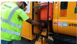
Los camiones con tolva de descarga siempre deben estar equipados con soportes firmes que estén adosados de forma permanente y que puedan bloquearse a fin de evitar que la tolva se baje por accidente mientras se hacen trabajos de mantenimiento o inspecciones.
